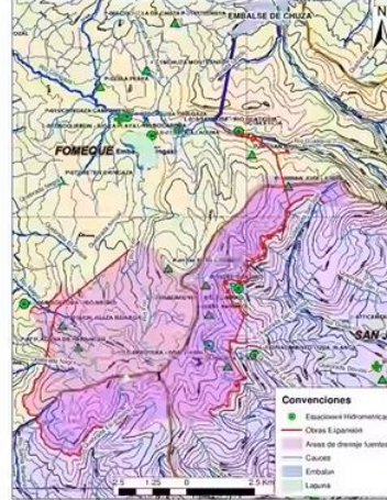
Áreas de drenaje de fuentes para proyecto de expansión Chingaza Sureste Caudal medio de 1,96 m 3 /s
