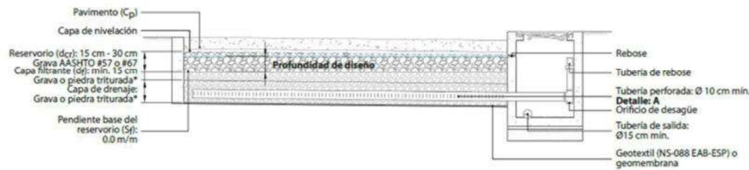
Figura 35. Corte: Pavimento permeable estándar: Corte BB
