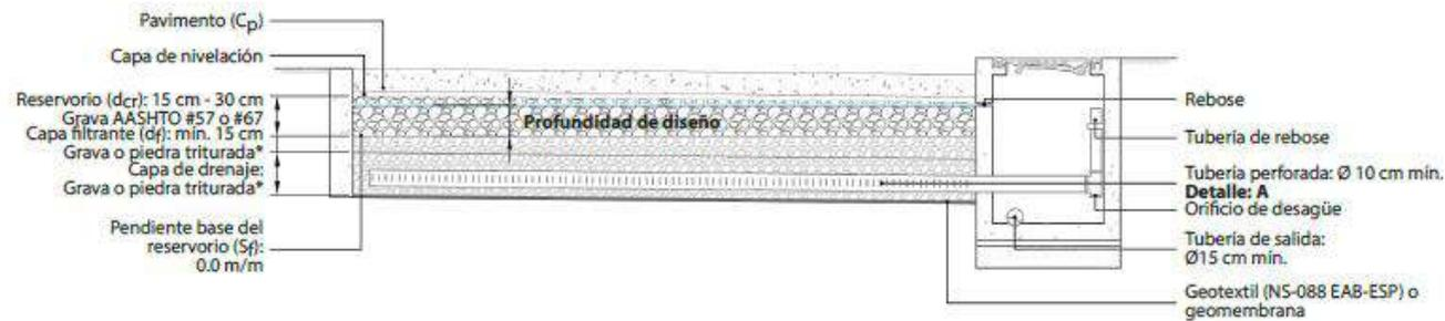
Figura 35. Corte: Pavimento permeable estándar: Corte BB
