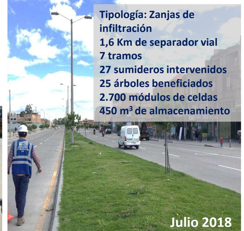
Tipología: Zanjas de infiltración
