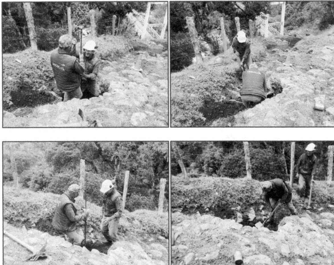
Figura 3. Actividades de exploración mediante la utilización de pruebas de CBR y ensayos de campo de pruebas de cono de penetración dinámico PDC.
