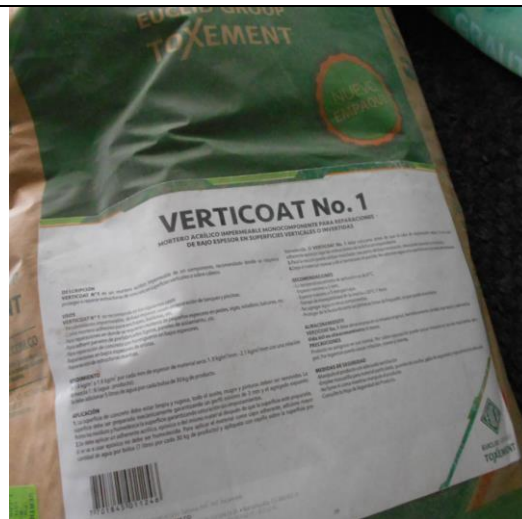
Imagen 14. VERTICOAT No.1. mortero acrílico impermeable de un componente, se empleó en el sello de regatas
