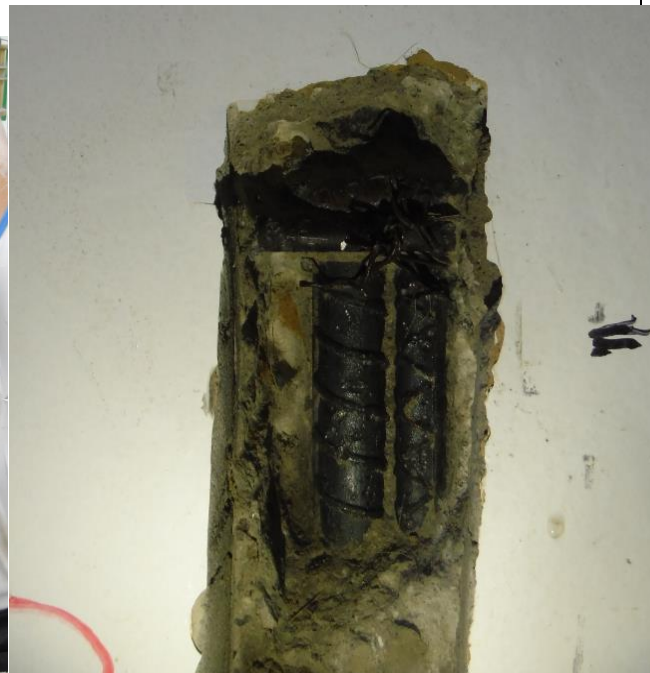
Fotografía 18. Acero 1/2" y 5/8 pulgadas en acero corrugado
