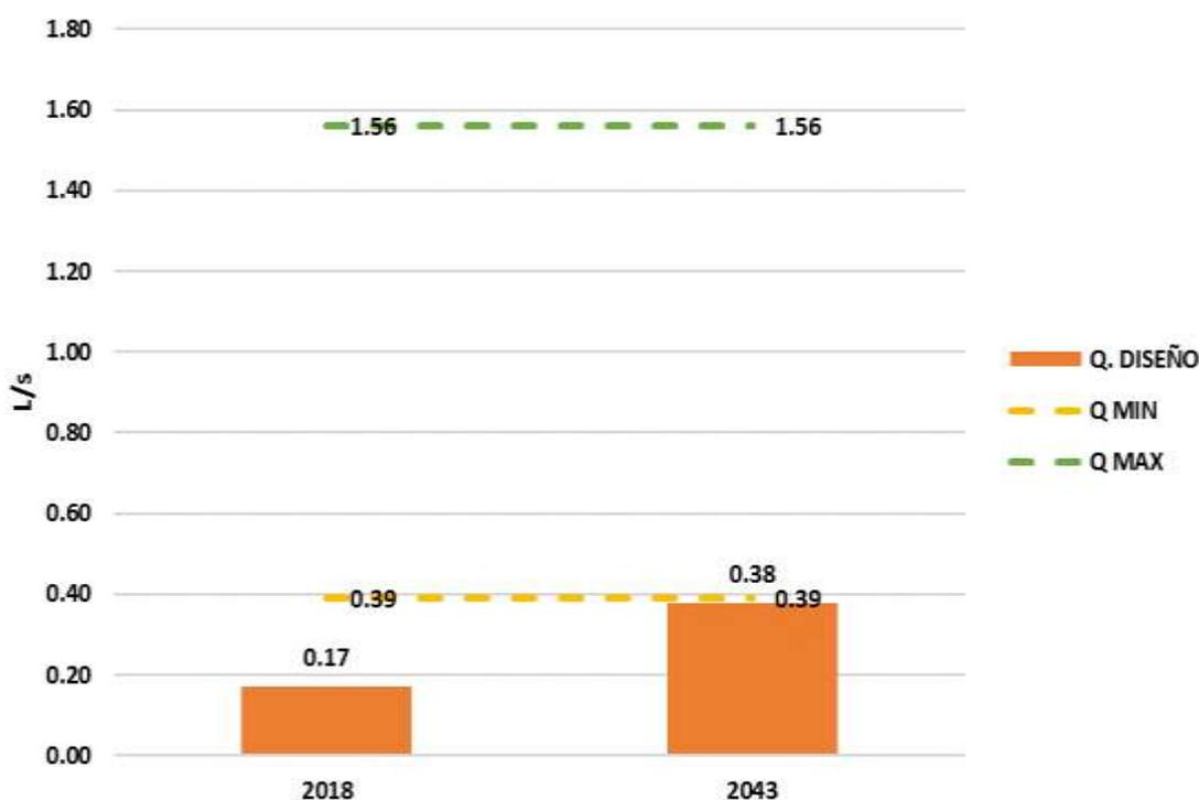
**Figura 2.218 Capacidad Limitante del Sedimentador**
