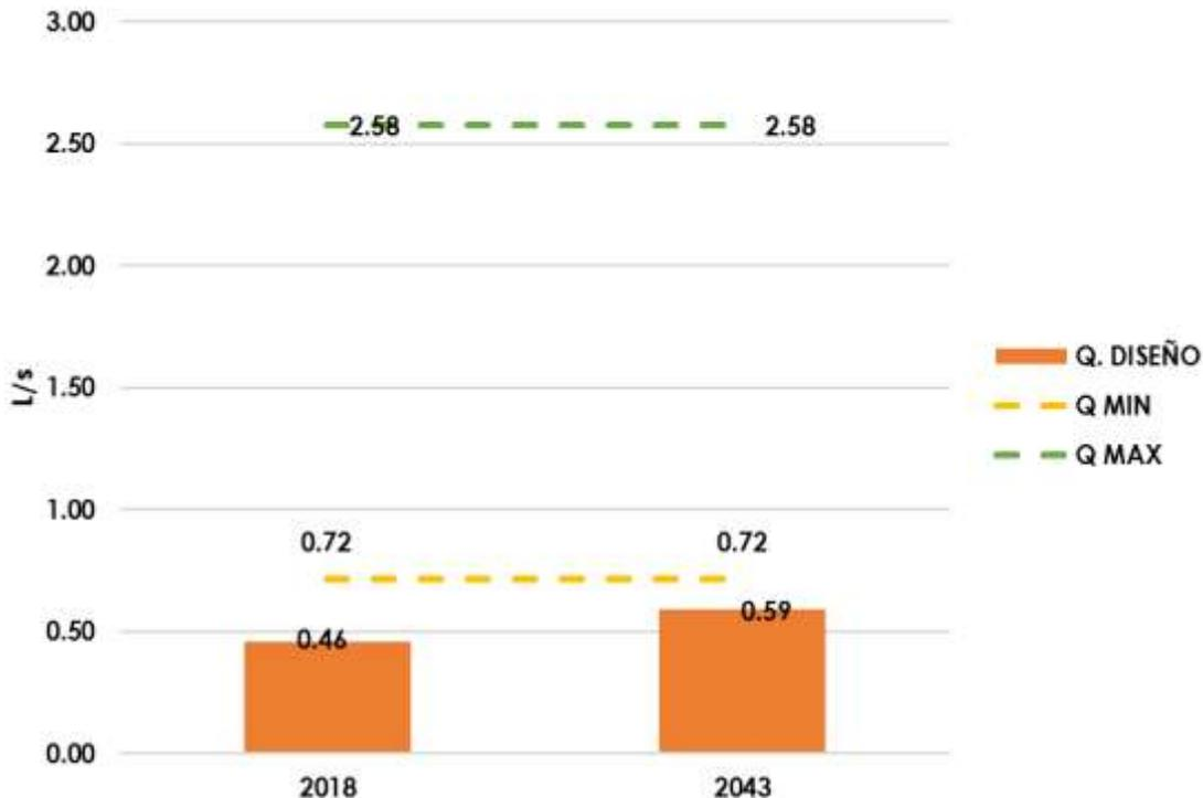
**Figura 2.271 Capacidad limitante del sedimentador**
