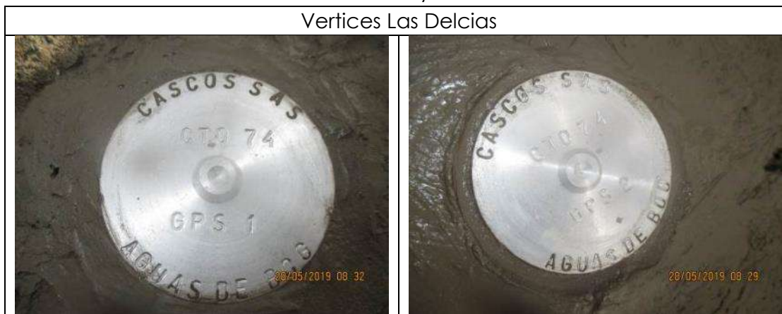
Fotografía 10 Referencias Materializadas y Posicionadas Mediante Proceso GPS (GPS1 y GPS2)
